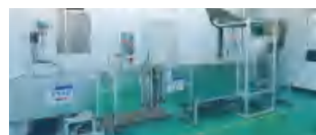
滑油散热器专用试验台
